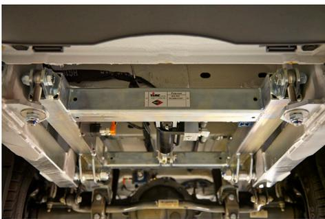
Patentierte hydraulische Achsblockierung
