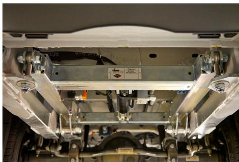
Patentierte hydraulische Achsblockierung
