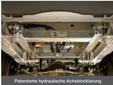
Patentierte hydraulische Achsblockierung
