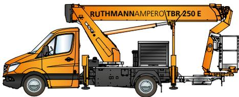
Im ersten vollelektrischen **E-STEIGER® AMPERO TBR 250 E** haben wir ein einzigartiges Konzept umgesetzt. Beim AMPERO wird zentral nur **eine Batterie für den Fahrtrieb** des ORTEN-Sprinters und gleichzeitig für den **STEIGER®-Antrieb** genutzt. Mit dem AMPERO fahren und arbeiten Sie **geräuscharm sowie abgasfrei**. Diesel-Fahrverbote sind mit dem E-STEIGER® kein Problem mehr.
