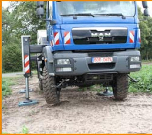
Die speziell für Allrad-Chassis entwickelte „HV“-Stütze ist optimal für Einsätze auf unbefestigten Straßen und Plätzen geeignet. Mobilfunk, Freileitungsbau, Baumpflege etc. auf der „grünen Wiese“: kein Problem.
