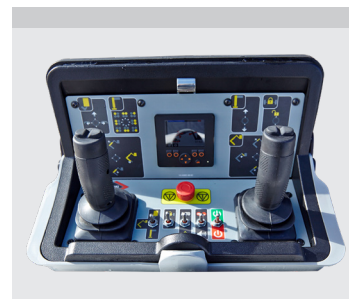
Vollproportionale-CANbus-Steuerung: Variable Reichweite (mit Wägezelle) und bis zu 4 Bewegungen gleichzeitig
